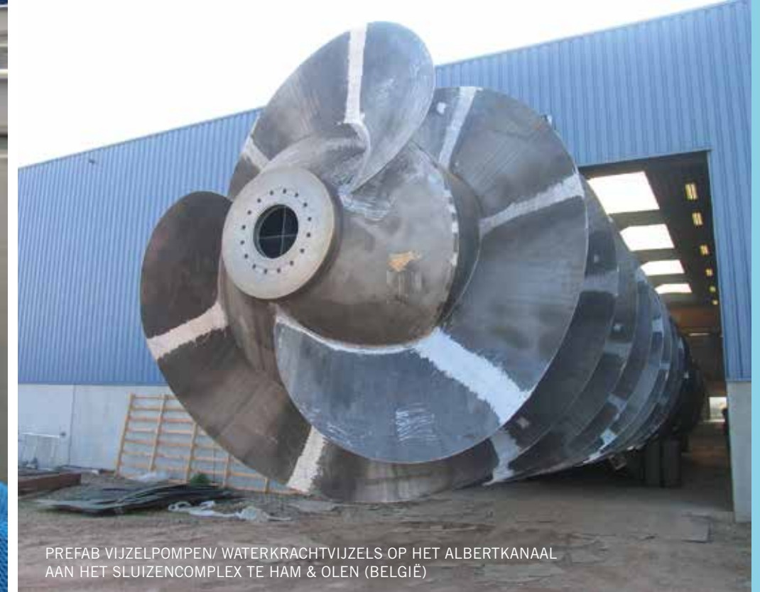
PREFAB VIJZELPOMPEN/ WATERKRACHTVIJZELS OP HET ALBERTKANAAL AAN HET SLUIZENCOMPLEX TE HAM & OLEN (BELGIË)
