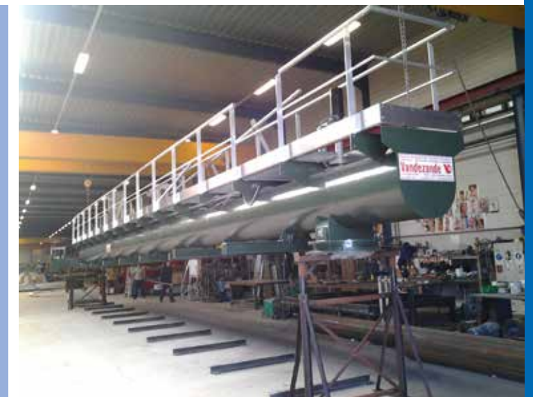
Ruimerbrug stalen buisconstructie - diameter tank 15 m - Bastogne (België)
