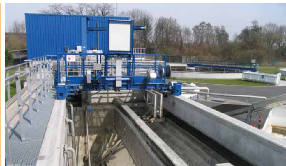
Langzandvanger met airliftsysteem Step Tubize (België)
